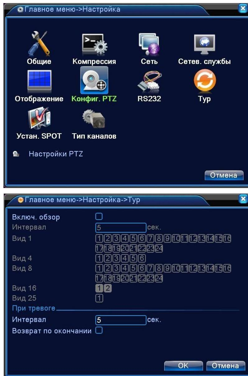
Рисунок 4.35 Настройка патрулирования
