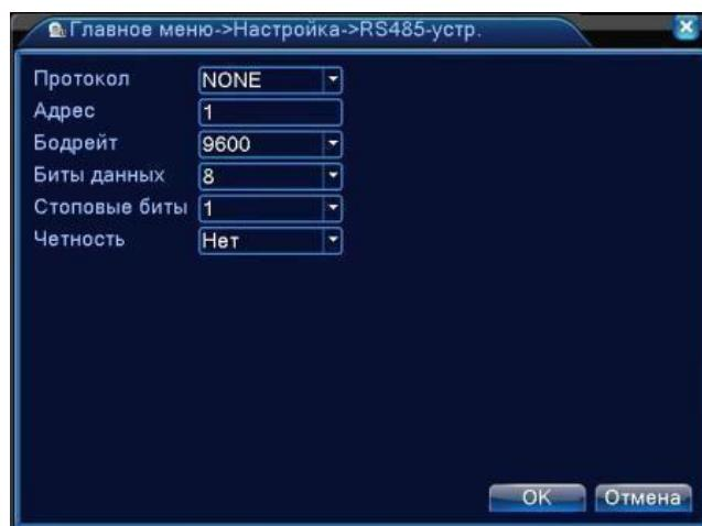
Рисунок 4.33 Конфигурация RS485 устройств в цифровом режиме.
