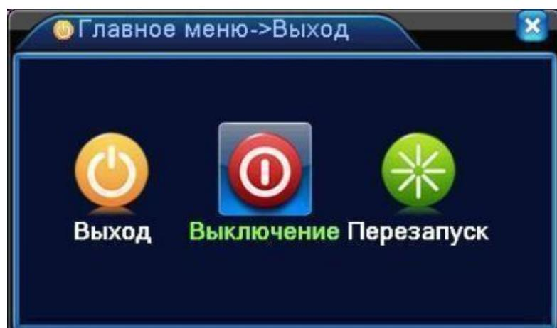
Использование выключателя питания называется жестким выключением (не рекомендуется, т.к. имеется вероятность повреждения HDD).
