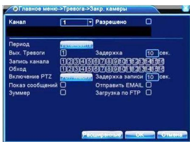
Закрытие камеры в полностью цифровом (NVR) режиме
