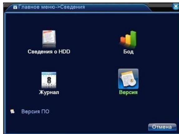
Показывается базовая информация такая как: аппаратная версия, версия программного обеспечения, дата выпуска, серийный номер, состояние NAT и т.п.
