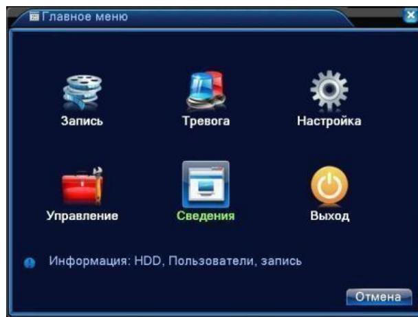
Информация о жестком диске, статистика кодового потока, журнал, версия прошивки программного обеспечения.
