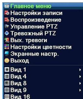
Рис. 3.2а Меню функций в полностью аналоговом/гибридном режиме
