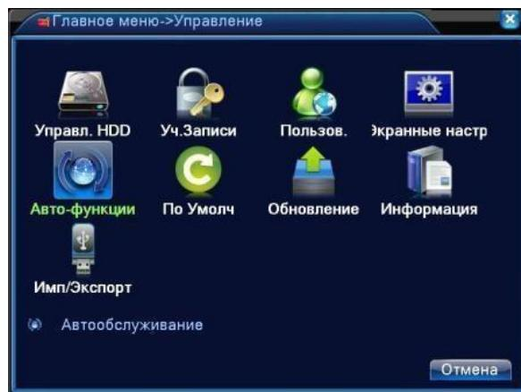
Пользователь может настроить время автоматической перезагрузки и автоматического удаления файлов.
