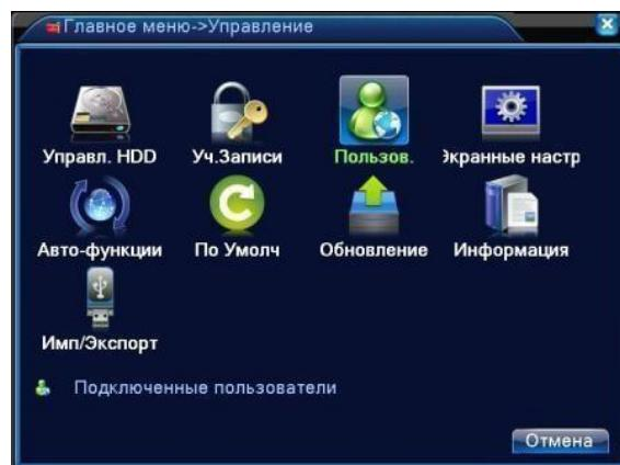
Используется для проверки информации о пользователе в сети, который подключен с помощью местного устройства. Возможно, также, разорвать соединение пользователя. Чтобы разорвать соединение, надо поставить √ в поле, и нажать **Отключить**. Соединение с пользователем будет прервано и не восстановится, пока устройство не перезагрузится.
