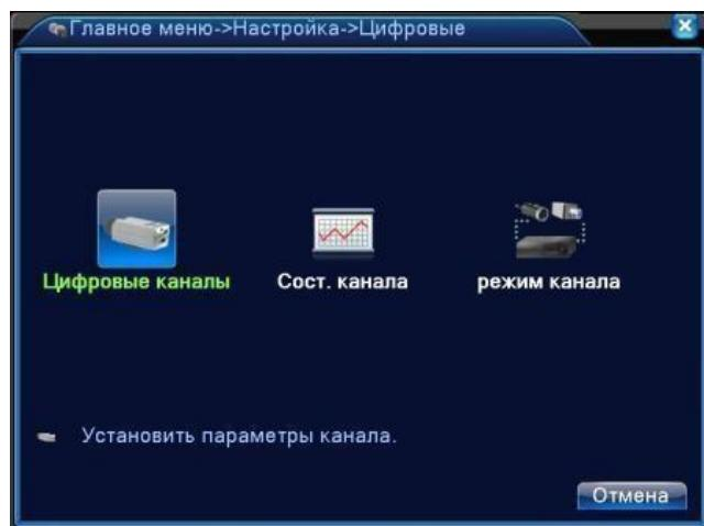
Управление каналами в гибридном(HVR) и полностью цифровом режиме(NVR)
